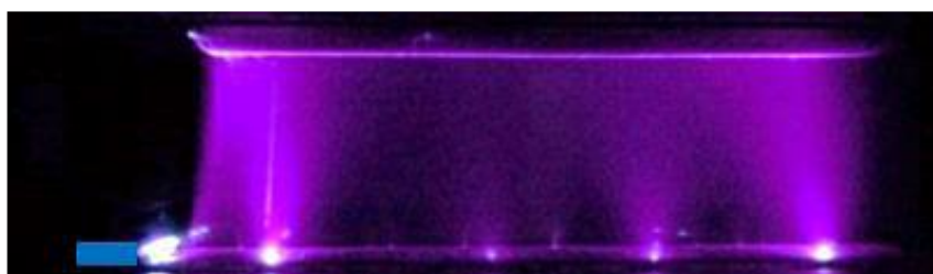
Рис.10. Свечение импульсного объемного разряда с предионизацией при дифракции ударной волны на препятствии на нижней стенке.
