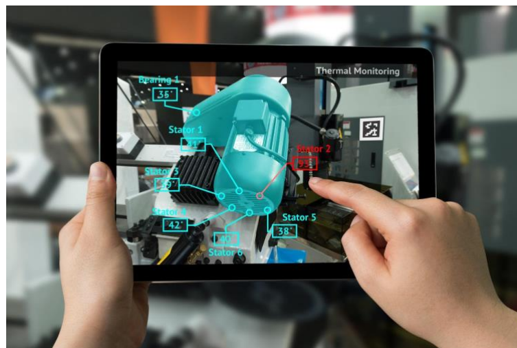
Рис. 2 – Система пространственного моделирования и визуализации пространственной сцены, состоящей из трёхмерной модели абстрактного объекта, в виде оболочки установки, а также дополнительных объектов в виде указателей и подписей на 6 её статоров, отображённая с использованием СДР.
