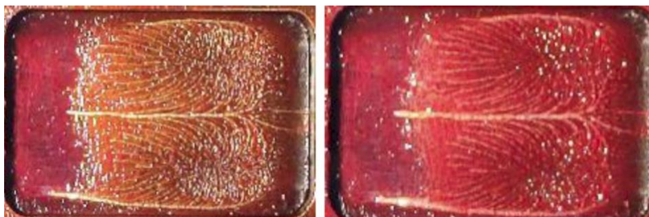
Рис. 11 Картина предельных линий тока через 60 и 80 с после выключения потока. M=0.7
