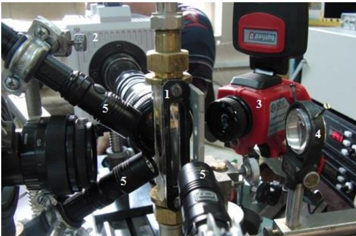
Рис. 1. Общий вид установки, измерительной и вспомогательной аппаратуры. Цифрами обозначены: 1 – рабочий участок; 2 – камера для высокоскоростной видеосъемки; 3 – тепловизионная камера; 4 – линза для фокусировки лазерного излучения; 5 – фонари подсветки.
