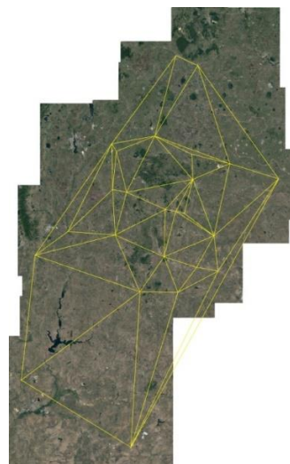
Рис. 1.2. Триангуляция локализованных опорных точек (РАО) на снимке со спутниковой карты
