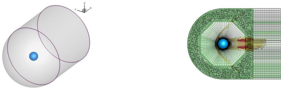
а) расчетная область б) вид адаптивной сетки в сечении Y = 0 Рис. 7. Геометрия расчетной области и структура адаптивной сетки для расчета сверхзвукового обтекания сферы.
