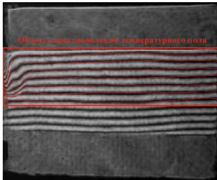
Рис. 5. Аппроксимация кривыми Безье интерференционных полос на сдвиговой интерферограмме.
