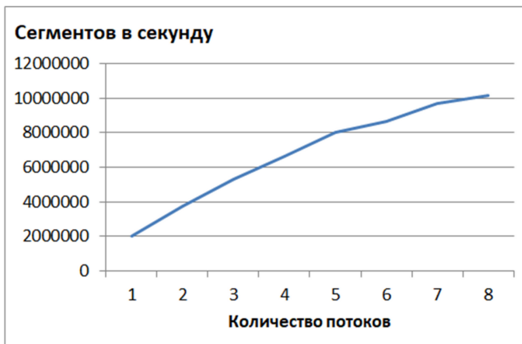
Рис. 10. Зависимость скорости обработки трехмерной карты лучей от количества используемых потоков.
