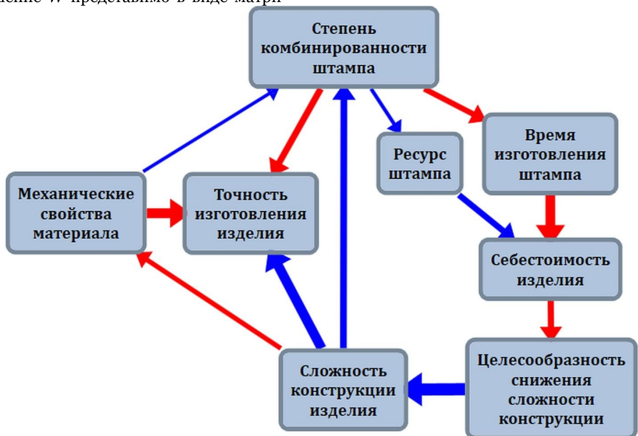
Рис. 1. Нечеткая когнитивная карта для задачи выбора технологии изготовления штампованного изделия
